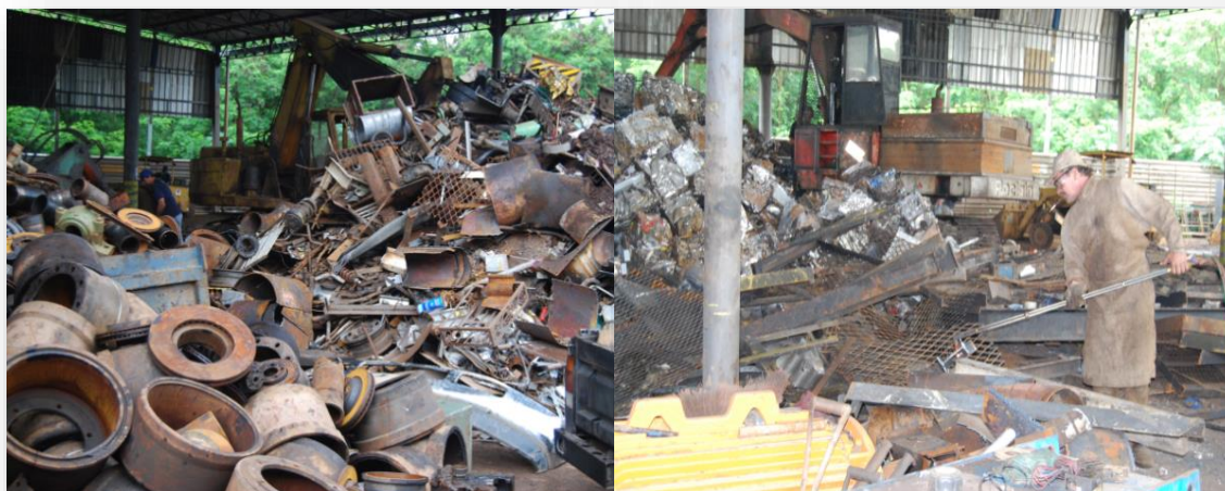
Figura 1 - Sucata ferrosa sendo separada e cortada para posterior envio à siderurgia.
