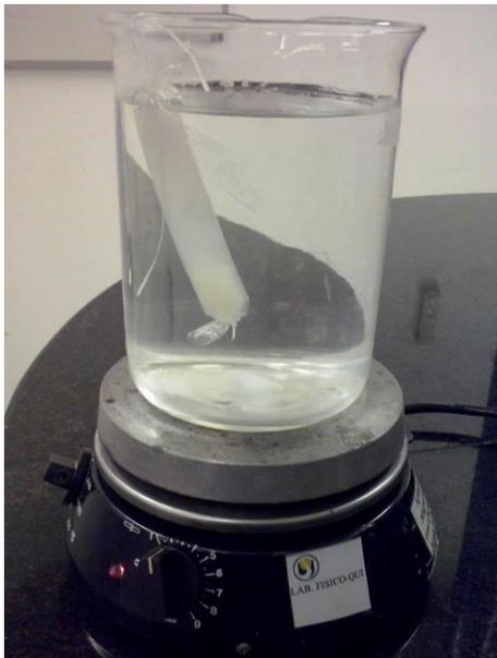
Geralmente é reportado na literatura o uso de membranas de 3.500 Da; neste caso utilizou-se membrana de celulose MWCO 12.000 Da.
