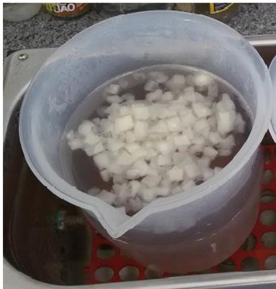
Em uma cuba de aquecimento (ou um banho Maria) coloca-se um béquer contendo uma solução de  $\text{Na}_2\text{CO}_3$  (carbonato de sódio) na proporção: 2L de água MiliQ (água deionizada) para 4,24 g de  $\text{Na}_2\text{CO}_3$ .
